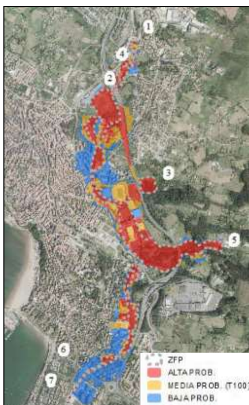
Imagen 4. Nueva delimitación de la inundabilidad en la zona de flujo preferente en Getxo. 1 y 5 río Gobela, 2 río Kanderu, 3 río Itzaerreka, 4 río Larrañazubi, 6 y 7 salida-1 y 2. Fuente: URA y Confederación Hidrográfica Cantábrico Oriental. Junio 2021
